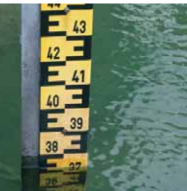
Wasserstandsmessung: Am Pegel kann die exakte Höhe ermittelt werden.
